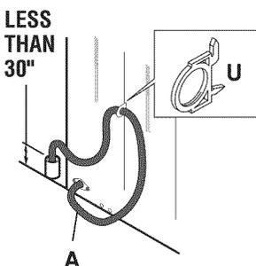
NOTA: Si se requiere una manguera de drenaje más larga, mande a pedir el equipo de extensión de la manguera de drenaje, número de pieza de drenaje, número de pieza de drenaje, incluida en el equipo de extensión) a la manguera original usando la abrazadera para la manguera (también incluida en el equipo de extensión).
