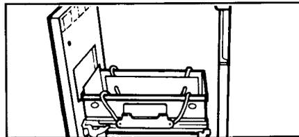
2. Mettre le compartiment à sac dans le tiroir. Glisser les courroies derrière les fixations, tel qu'il est illustré.
