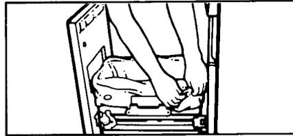
5. Fixer le sac en repliant les rebords sous la fixation et en introduisant les quatre trous préperforés aux boutons de fixation. Ces trous se détendent sans déchirer le sac.
