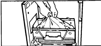
3. Fermer le sac avec les attaches à torsion fournies.
