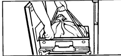
4. Retirer les courroies des fixations latérales et les tenir. **Pour faciliter l'enlèvement du sac**, ouvrir le côté du tiroir en déclenchant le loquet situé à l'avant. Soulever le sac et le compartiment du tiroir.
