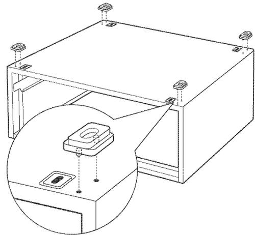
**REMARQUE : les coussinets de support doivent être installés seulement sur la sècheuse. N'INSTALLEZ PAS CES COUSSINETS SUR LE SOCLE DE LA LAVEUSE.**
