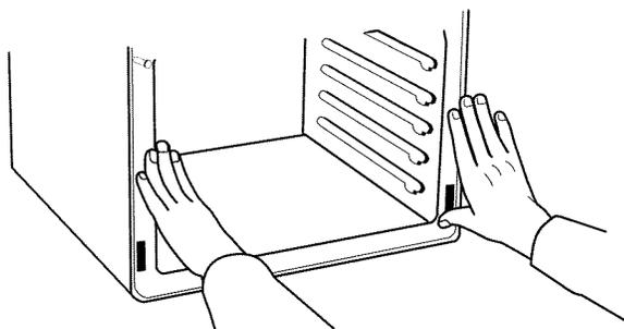
4. Fixer solidement le four au placard à l'aide des deux vis autotaraudantes de 4 x 25 mm fournies. Insérer les vis à travers les trous des rails de montage. Ne pas serrer excessivement les vis.
