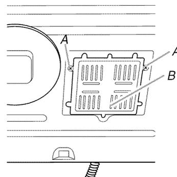
A. Vis du couvercle du boîtier de connexion
