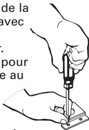
**NOTE :** Les vis de fixation de la bride antibasculement doivent être solidement ancrées dans le sous-plancher. Selon l'épaisseur du plancher, il peut être nécessaire d'utiliser des vis d'ancrage plus longues pour qu'elles prennent prise dans le sous-plancher. On peut trouver des vis d'ancrage plus longues dans tout magasin de quincaillerie local.
